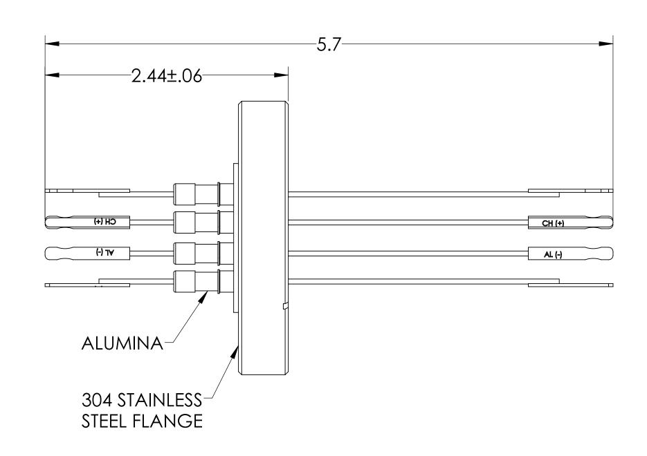
AIR-SIDE CONNECTOR VACUUM-SIDE CONNECTOR
