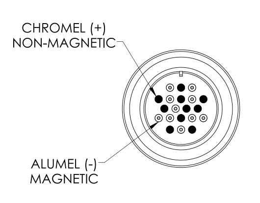
AIR-SIDE CONNECTOR VACUUM-SIDE CONNECTOR
